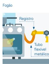
➤ Os fogões devem estar conectados à instalação por um tubo flexível metálico (NBR no 14.177) com registro de esfera, contendo a identificação, e instalados sempre em local ventilado e de fácil acesso.
